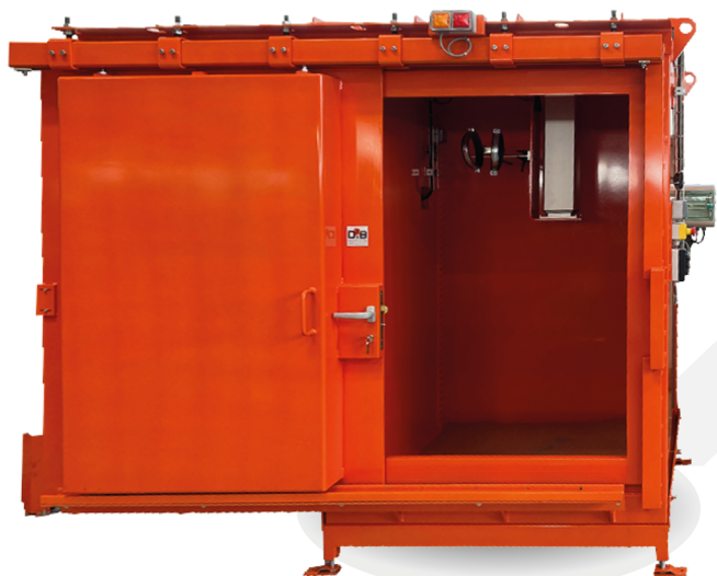
Cabine Monobloc sur pieds 200KV - 1,5 x 1,3m - 10mm Plomb
